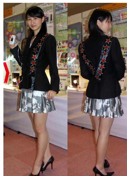
Figura 1. Complemento solar que Gunze Co., Ltd., Japón, produce en cooperación con el profesor Tsukasa Yoshida de la Universidad de Gifu, Japón. Se trata de 26 células de plástico en forma de estrella de tecnología DSC con eficiencia de 1,4% combinadas con la ropa que permiten cargar un teléfono móvil.
