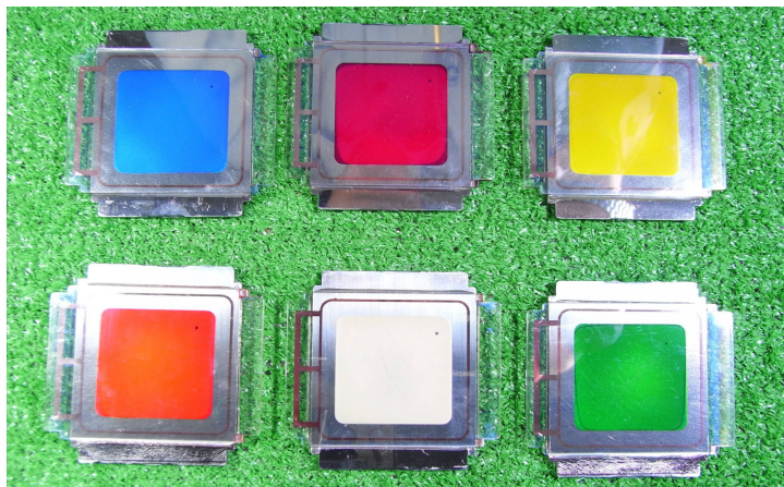
Figura 3. Células solares de plástico basadas en tecnología DSC desarrolladas por Sekisui Jushi Corporation de Japón, en cooperación con el profesor Tsukasa Yoshida de la Universidad de Gifu, Japón. Mediante combinaciones de colorantes sensibilizadores de los tres colores primarios (amarillo, magenta, cian) pueden crearse todos los colores. La célula blanca emplea un colorante absorbedor en el infrarrojo desarrollado por el profesor Kazumasa Funabiki de la Universidad de Gifu, Japón.
