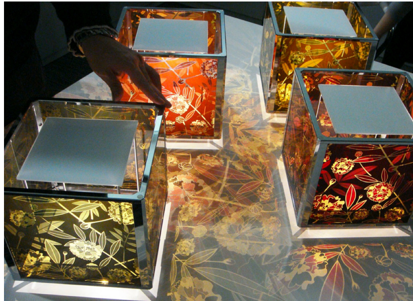
Figura 5. 'Hana-Akari' ('flor de luz' en japonés), preparada por la doctora Reiko Ogura, de Sony Corp., Japón. Las hojas y flores son células solares DSC que captan la luz interior, produciendo electricidad que alimenta los LED para iluminación.
